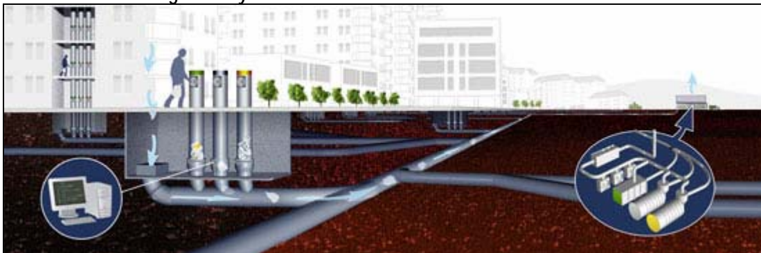
Figure 5. Système fixe de collecte souterraine des déchets
